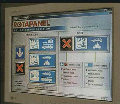
Sie können Ihre variable Wechselsignal entweder online über einen PC steuern oder unverkabelt über ein GSM-Handy. Dank der offenen Softwarearchitektur können die Wechselsignale an die spezifischen Wünsche des Kunden angepasst werden.
